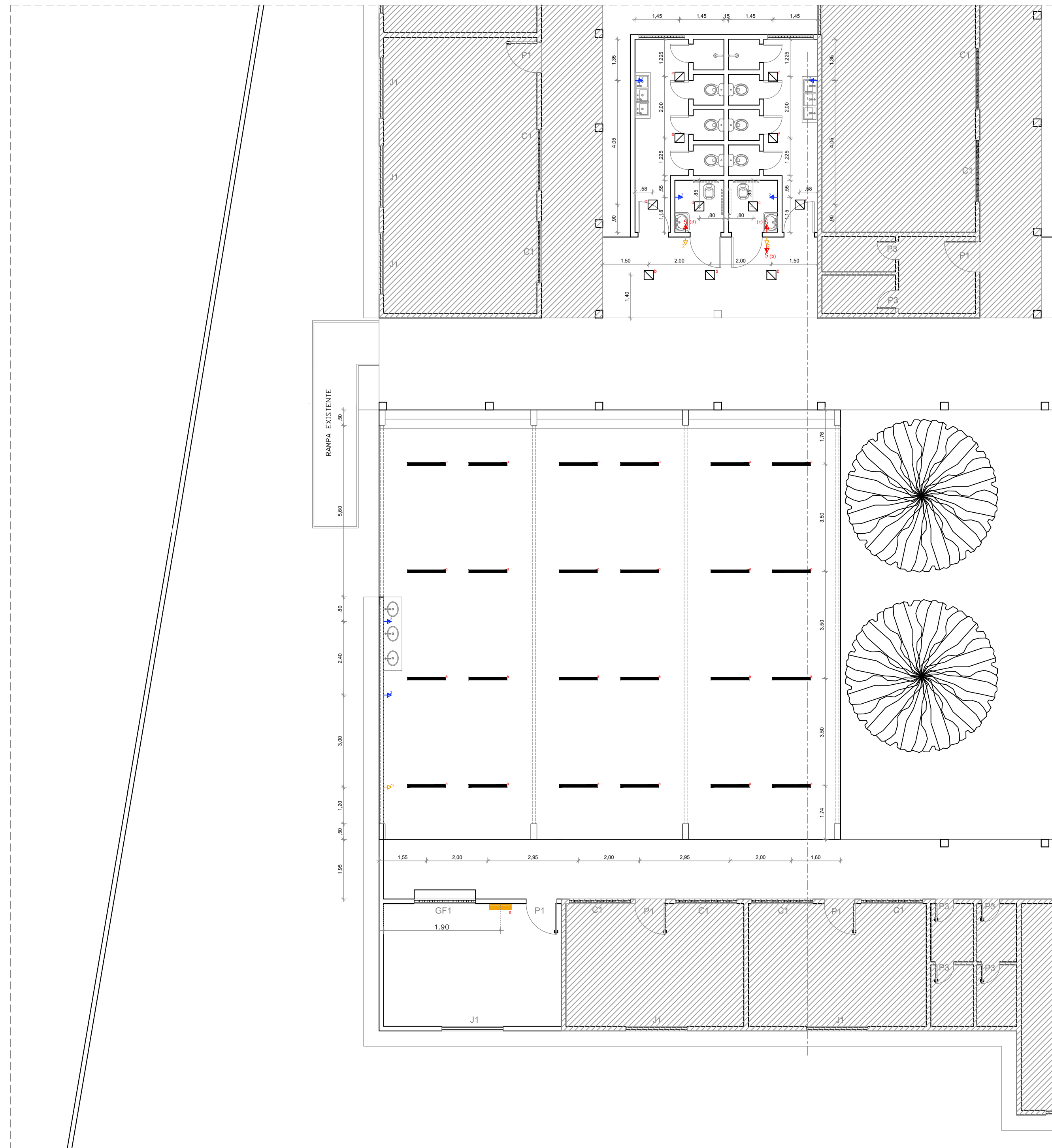
6 PLANTA PONTOS ELÉTRICOS E LUMINOTÉCNICOS ESCALA 1:100
