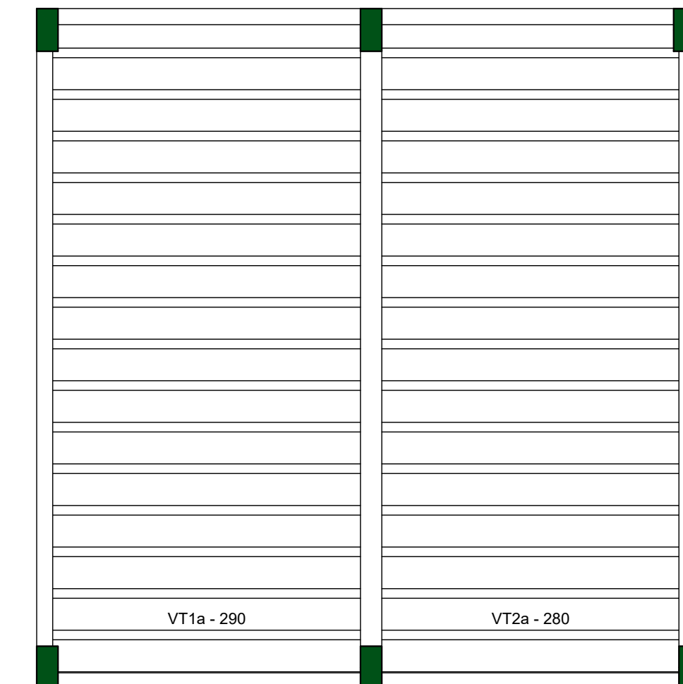
Planta de vigotas pré-moldadas escala 1:50
